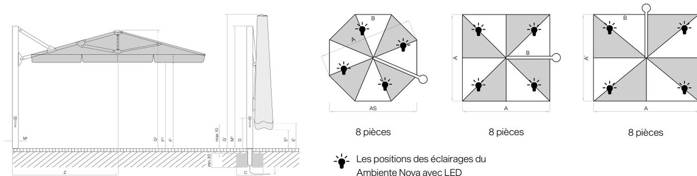
Revêtement de chaussée non fixé max. 10 cm, épaisseur du béton min. 30 cm (tenir compte de la profondeur hors gel), Garantir l'écoulement de l'eau, Ligne d'alimentation électrique.
